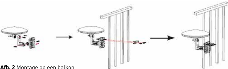
Afb. 2 Montage op een balkon
