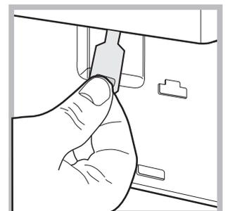
4. utilizando la lengüeta indicada en la figura, tire hacia fuera hasta liberar la varilla de plástico del retén; tire posteriormente hacia abajo hasta sentir un breve sonido que indica que la puerta está desbloqueada.
