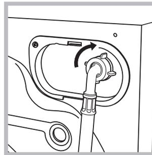
2. Conecte el tubo de alimentación a la lavasecadora enroscándolo en la toma de agua correspondiente ubicada en la parte posterior derecha (arriba) (ver la figura).
