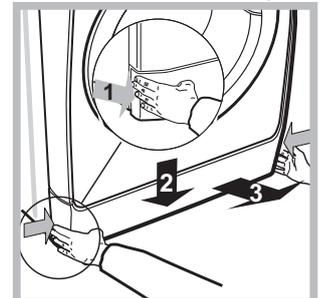
sea inferior al hueco de la puerta; si no es así, extraiga el agua en exceso utilizando el tubo de descarga y recogiéndola en un balde como se indica en la figura.
