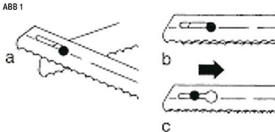
Insérer les 2 lames montées, en les tenant par l'embout plastique, dans les 2 fentes situées à l'avant de votre couteau électrique jusqu'à entendre le clic de sécurité. Celles-ci sont ainsi bloquées.
