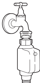
tubo de suministro de seguridad
