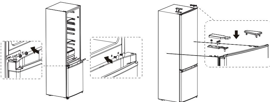
Het volgende moet worden gecontroleerd voordat de bovenste scharnierafrondekking wordt geïnstalleerd: De schroeven die het scharnier vasthouden, moeten stevig tegen het scharnieroppervlak worden gedrukt om te voorkomen dat de schroef schuin wordt geplaatst. Nadat het scharnier is geïnstalleerd, moet worden gecontroleerd of er geen speling of beweging is.
