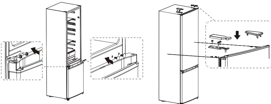
Confirmez les points suivants avant d'installer le cache de charnière supérieure. Les vis qui maintiennent la charnière doivent fermement appuyer sur la surface de la charnière pour garantir qu'elles soient droites. Une fois la charnière installée, vérifiez qu'elle ne bouge pas.
