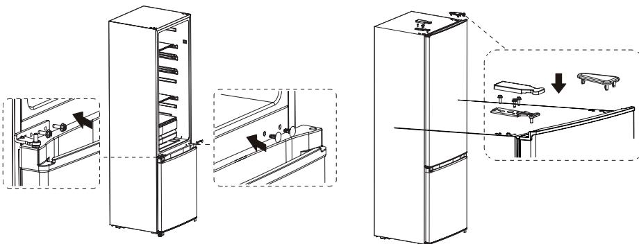
Deberá asegurarse de lo siguiente antes de instalar la tapa de la bisagra superior. Los tornillos que sujetan la bisagra deberán estar firmemente presionados contra la superficie de la bisagra para garantizar que el tornillo no se desvíe. Después de instalar la bisagra, asegúrese de que no haya vibraciones.
