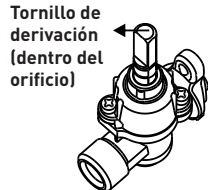
Válvula sin dispositivo de fallo de llama
