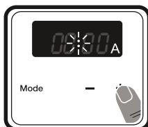
3. Na een aantal seconden stoppen de stippen met knipperen en blijven ze branden.
