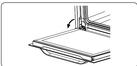
2. Abra el estribo (A) (con la ayuda de un destornillador) hasta la posición final.
