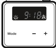
• Als de timer nul heeft bereikt, wordt de oven uitgeschakeld, klinkt een geluidssignaal en knippert het symbool 'A'. Draai beide regelknoppen naar stand '0' en druk op een willekeurige toets op de timer om het geluidssignaal te stoppen. Het symbool verdwijnt en de timer schakelt terug naar handmatig functioneren.
