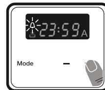
3. Het symbool Δ blijft branden, de tijd wordt opgeslagen en de waarschuwing wordt ingesteld.
