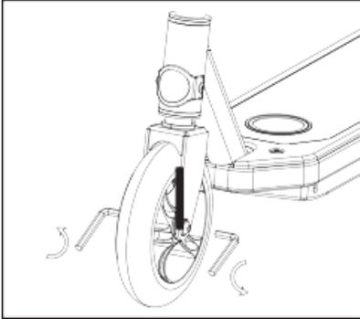
Entfernen Sie die Achse vom Vorderrad, indem Sie sich gegen den Uhrzeigersinn drehen und 2 x 5 mm Sechskantschlüssel verwenden.
