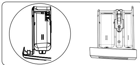
Dit vak is bedoeld voor vloeibaar wasmiddel of waspoeder of ontkalker. De niveauplaat voor vloeibaar wasmiddel wordt in uw machine meegeleverd. (\*)
