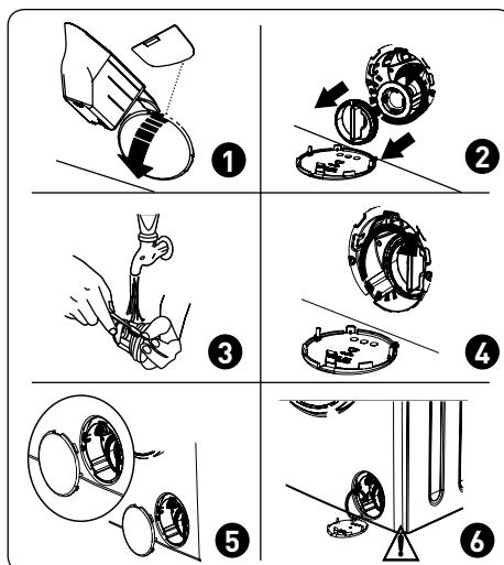
Het pompfiltersysteem in uw wasmachine verlengt de levensduur van de pomp door te voorkomen dat er pluizen in uw machine terechtkomen. We raden u aan uw pompfilter iedere 2 maanden te reinigen. Het pompfilter bevindt zich achter het deksel op de rechter voorste hoek onderaan. Reinigen van het pompfilter:
