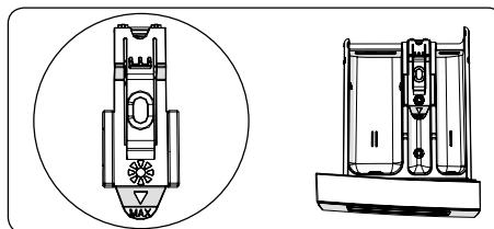
Ce compartiment est destiné aux assouplissants, aux adoucissants ou à l'amidon. Suivre les instructions figurant sur l'emballage. Si les assouplissants laissent des résidus après utilisation, essayer de les diluer ou d'utiliser un assouplissant liquide.
