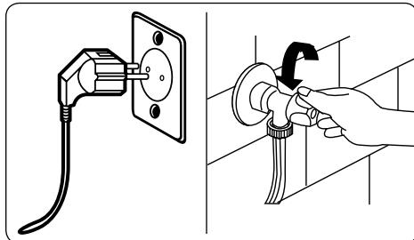
Schakel uw netvoeding uit en trek de stekker uit het stopcontact alvorens onderhoud en reiniging van uw machine uit te voeren. Draai de watertoevoer dicht als uw machine onderhoud of reiniging ondergaat.
