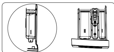
Utiliser uniquement ce compartiment lorsque la fonction Prélavage a été sélectionnée. Il est conseillé de sélectionner cette fonction avec du linge très souillé uniquement.
