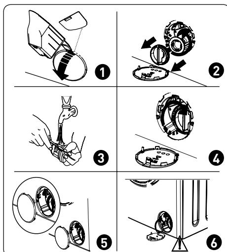
El sistema de filtro de bomba de la lavadora alarga la vida de la bomba al impedir que entren pelusas en la máquina. Recomendamos limpiar el filtro de la bomba cada dos meses. El filtro de la bomba se encuentra tras la tapa que hay en la esquina inferior derecha de la parte frontal de la máquina. Para limpiar el filtro de la bomba:
