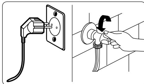
Avant toute opération d'entretien ou de nettoyage, il convient de couper l'alimentation secteur et de débrancher la prise de la machine. Couper l'alimentation en eau avant de démarrer l'entretien ou le nettoyage.
