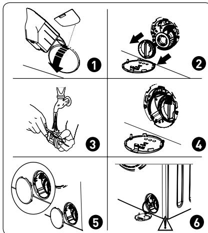
Le système de filtre de la pompe de vidange du lave-linge permet de prolonger la durée de vie de la pompe en prévenant toute pénétration de peluche. Nous recommandons de nettoyer le filtre de la pompe de vidange tous les 2 mois. Le filtre de la pompe de vidange est situé derrière la trappe d'accès, dans le coin inférieur droit de la façade de la machine. Pour nettoyer le filtre de la pompe de vidange :
