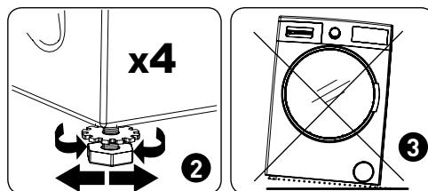
**②** Para aumentar la altura de la máquina, gire la pata en el sentido de las agujas del reloj. Para reducir la altura de la máquina, gire la pata en el sentido contrario al de las agujas del reloj.
