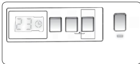
Puede utilizar esta función auxiliar para retrasar la hora de inicio del ciclo de lavado de 1 a 23 horas.
