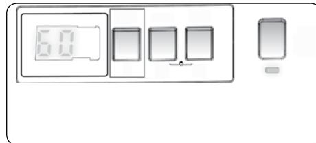
Wanneer u een programma kiest, wordt automatisch de maximumtemperatuur voor dat programma geselecteerd. Om de temperatuur aan te passen, drukt u op de regelknop watertemperatuur totdat de gewenste temperatuur wordt weergegeven op het digitale display. U kunt de watertemperatuur geleidelijk laten afnemen tussen de maximale temperatuur van het gekozen programma en keuzes voor koud wassen (- C) door op de regelknop voor de watertemperatuur te drukken.
