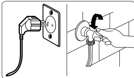
Apague la lavadora y desconecte el enchufe de la toma eléctrica antes de llevar a cabo tareas de mantenimiento y limpieza en la máquina. Cierre el suministro de agua antes de comenzar las tareas de mantenimiento y limpieza en la máquina.
