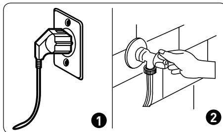
**1** Steek de stekker van uw machine in het stopcontact..
