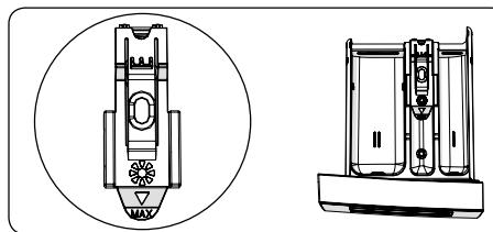
Dit vak is bedoeld voor wasverzachters of stijfsel. Volg de instructies op de verpakking. Als wasverzachters na gebruik resten achterlaten, probeer ze dan te verdunnen of gebruik een vloeibare wasverzachter.
