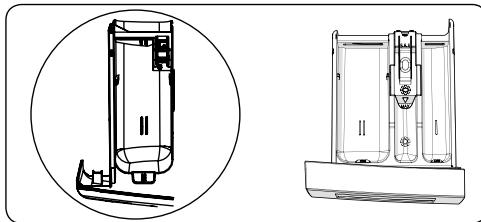
Ce compartiment est destiné aux lessives liquides ou en poudre ou aux produits anticalcaire. La réglette graduée (en option) pour lessive liquide est livrée à l'intérieur de la machine.(\*)
