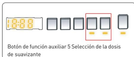
Esta función auxiliar permite activar o desactivar la dosis automática y ajustar los niveles de suavizante.
