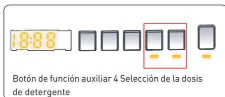
Esta función auxiliar le permite activar o desactivar la dosis automática y ajustar la cantidad de detergente líquido según el grado de suciedad de la ropa que introduce en su lavadora.
