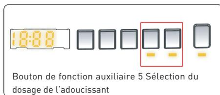
Cette fonction auxiliaire vous permet d'activer ou de désactiver le dosage automatique et de régler les niveaux de l'adoucissant.
