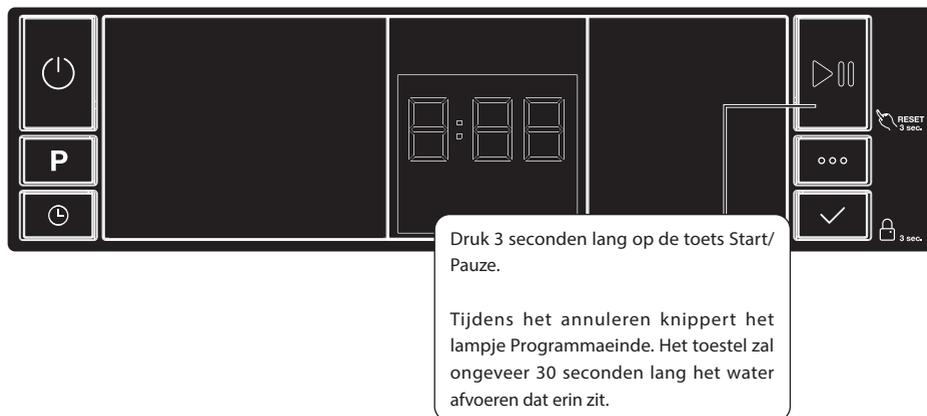
Wanneer het lampje Programmaeinde gaat branden, schakel uw toestel uit met de toets Aan/Uit.
