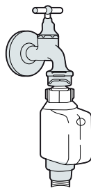
tubo de suministro de seguridad
