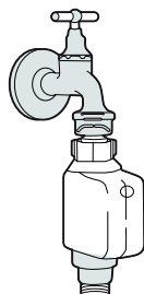
tubo de suministro de seguridad
