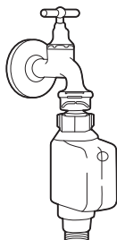
Tuyau d'arrivée d'eau de sécurité
