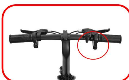
O visor do lado direito do guiador permite-lhe monitorizar o nível da bateria do seu aparelho.
