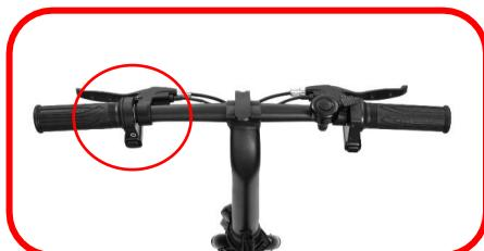
Como se muestra en la foto, el botón marcado en rojo permite encender y apagar el dispositivo. Pulse hacia arriba para encenderlo. Luego hacia abajo para apagar. Para encender la luz frontal, presione el botón debajo del indicador de batería durante 3 segundos.
