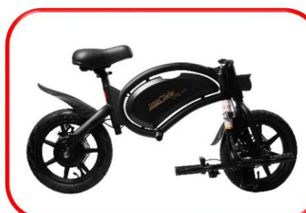
Pour déplier le guidon de votre vélo électrique, relevez-le et fixez-le grâce au verrou situé à sa base. Avant de rouler, vérifiez que votre guidon est bien serré et qu'il est stable.
