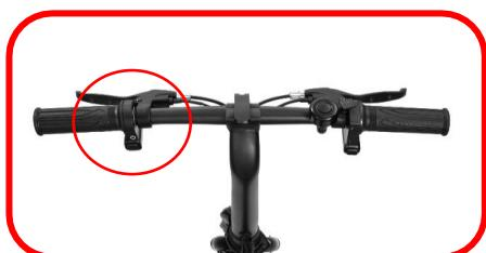
Como se mostra na fotografia, o botão de círculo vermelho é utilizado para ligar e desligar o seu dispositivo. Empurrar para cima para ligar. Em seguida, desligar-se. Para ligar a luz frontal, pressionar o botão abaixo do indicador de bateria durante 3 segundos.
