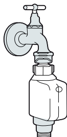
tubo de suministro de seguridad
