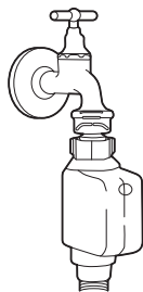
Tuyau d'arrivée d'eau de sécurité
